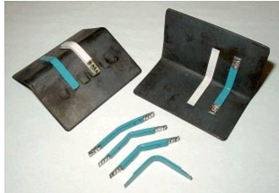
Obr. 2 Ohýbané viacvrstvové moduly na báze LTCC s vonkajšími a vnútornými uhlami ohybu Fig. 2 Bent multilayer modules on the base of LTCC by external and internal bent angles
